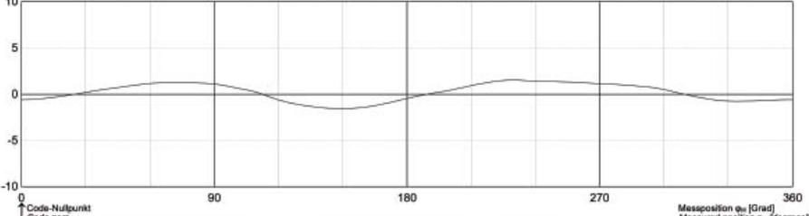
Die Messkurve zeigt die Mittelwerte der Positionenabweichungen aus 5 Vorwärts- und Rückwärtsmessungen ohne Umkehrspanne. Die Umkehrspanne wird an 10 Messpositionen im Schrittzyklus ermittelt. Die Strichzahl des Winkelmeßgerätes beträgt 18384.
